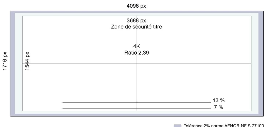
Fig. 4 : Dimensions et positionnement des lignes – Ratio 2,39
